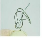
Quando il filo di NiTi è a temperatura ambiente è soffice e poco resistente
