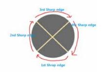
Una lama affilata capace di ruotare di 360° massimizza ed estende l'efficacia del taglio.
